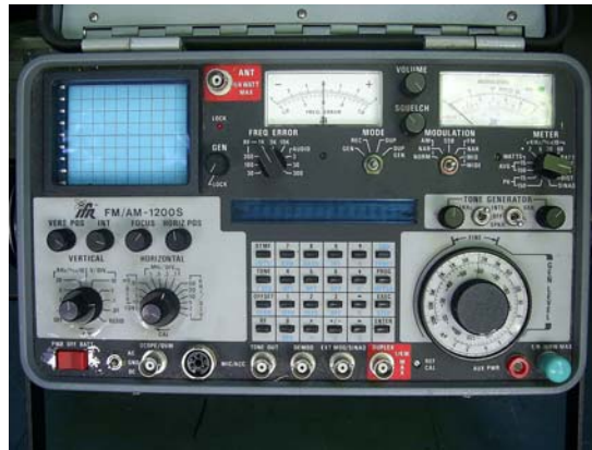
อุปกรณ์วัดสัญญาณ COMMUNICATION SERVICE MONITOR FM/AM- 1200S
