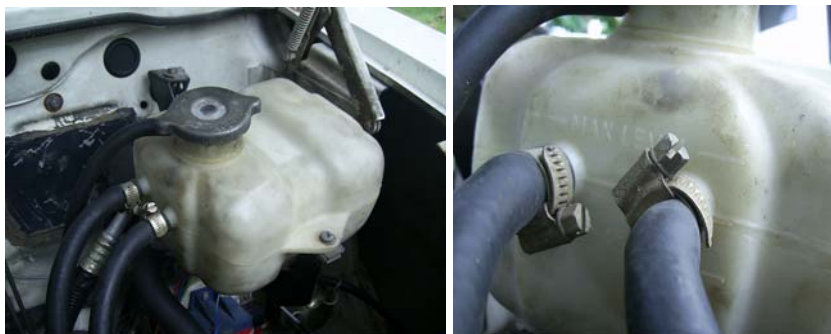
หม้อพักน้ำหล่อเย็น
