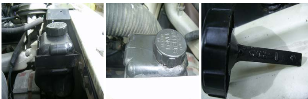
การตรวจเช็คระดับน้ำมันเพาเวอร์
